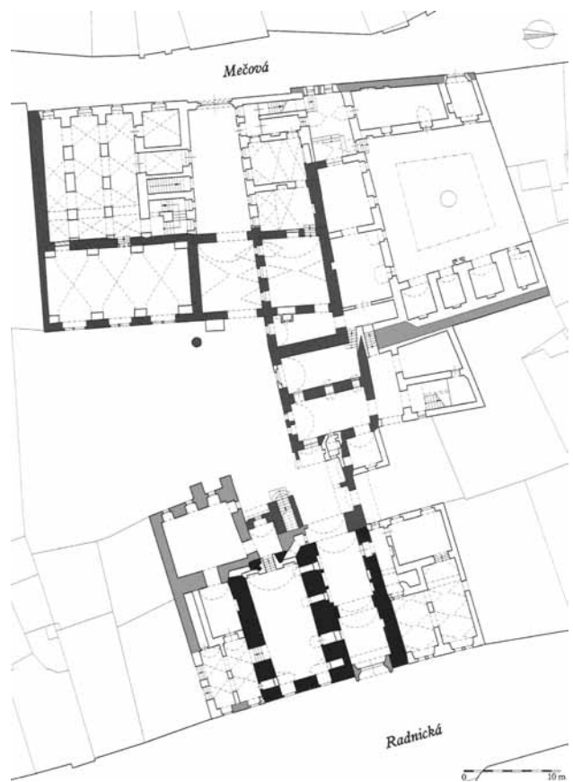
Altes Rathaus, Grundriss, Erdgeschoß. Schwarz: der älteste Kern, 13. Jahrhundert; hellgrau: 14.–15. Jahrhundert; dunkelgrau – Renaissance.
